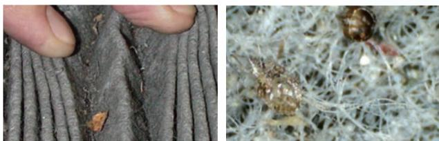
エアコンフィルターに詰まったホコリや枯れ葉など(左) マイクロスコープで拡大(倍率:100倍~200倍)すると、虫の死骸が...(右)
