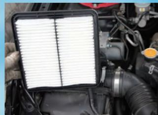
エアフィルターは主に「ビスカスタイプ」「ろ紙タイプ」「不織布タイプ」の3種類があり不織布タイプが現在の主流である。なお、基本的にどのタイプも清掃をしても本来の性能が発揮できないことから、汚れたら交換が鉄則である。クルマの使用状況や走り方、状態にもよるが、**車検時もしくは隙間の汚れ具合が目立つようであれば交換の目安になる。また走行距離が2万キロを超えた場合は、車検前でも交換をオススメしたい。**
